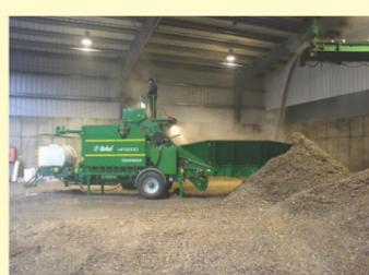
Die meisten Maschinen werden in der Industrie zum Pressen von Ersatzbrennstoff (Polyethylen) eingesetzt. Dadurch können Lager- und Transportkapazitäten geschaffen werden.
