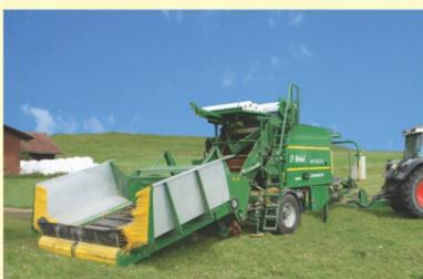
Von Orkel produzierte Serienmaschine mit Bunker, Schwenkdeichsel und Folienbindung. Einsatzbereit zum Maispressen.
